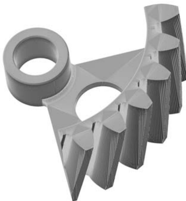
Rys. 3. Model STL fragmentu koła zębatego Fig. 3. STL model of a helical gear
